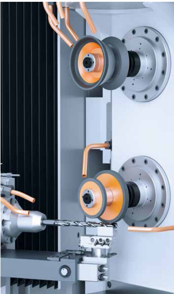
/// LÜNETTE für exakt dosierten Gegendruck beim Werkzeugschleifen
